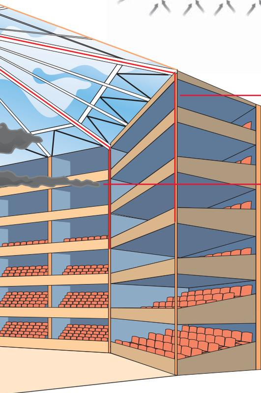
Las tuberías de muestreo Xtralis VESDA (en rojo) se pueden instalar en vertical. Esto garantiza que el humo se detectará cuando se extiende en horizontal.
